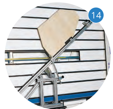
Angle cutting device Dispositivo para corte inclinado
