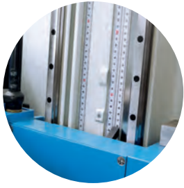
Linear guides Dos guías prismáticas
